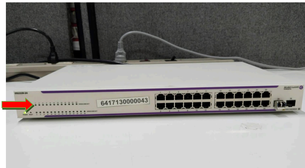
ภาพที่ 8 : แสดงไฟสีส้มดับลง Reset Switch เสร็จสิ้น ได้ค่าเริ่มต้นที่โรงงานผลิต ค่า Default
