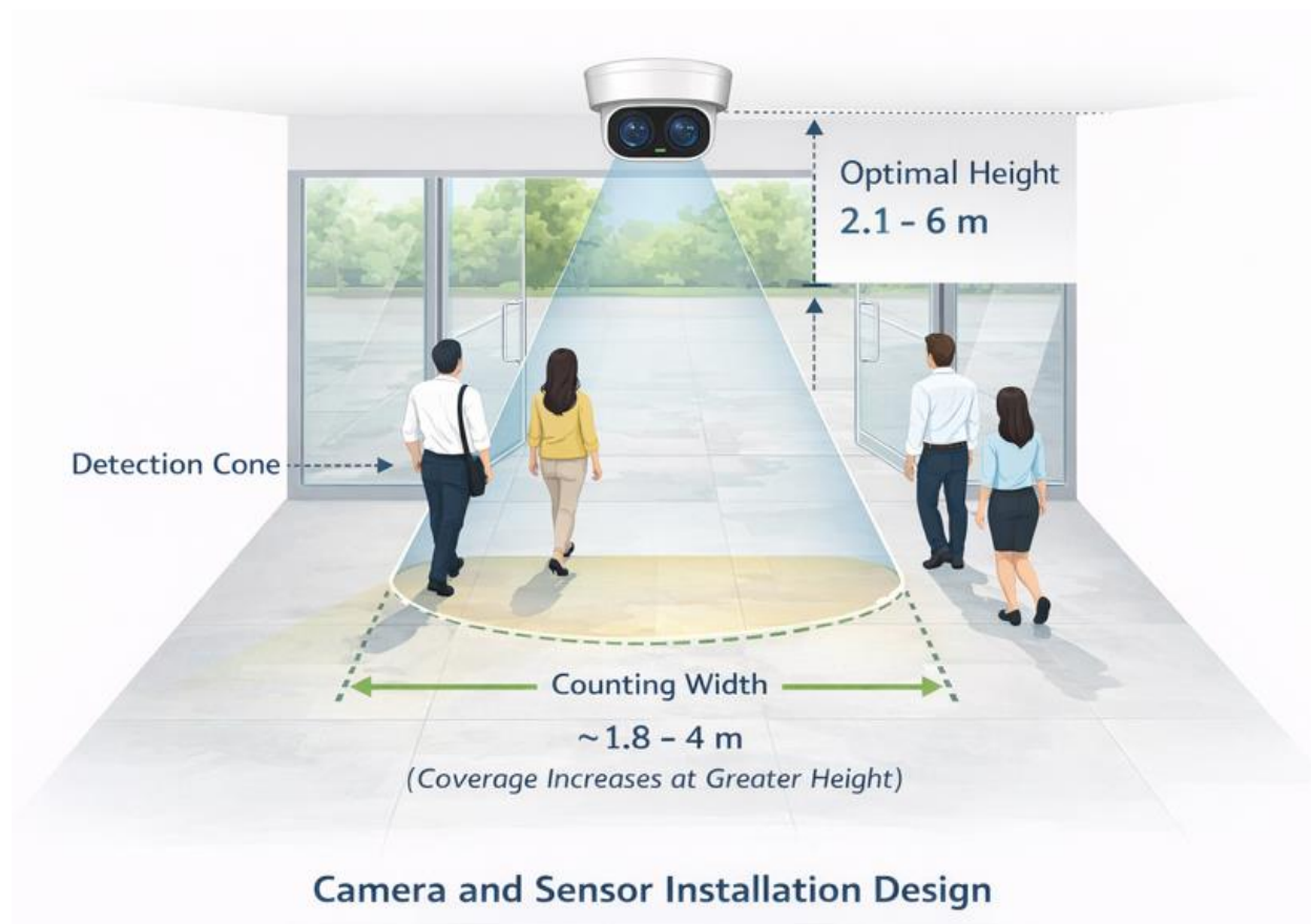
ภาพที่ 3.8 ภาพแนวตั้งของตำแหน่งการติดตั้งในมุมมองเซ็นเซอร์
