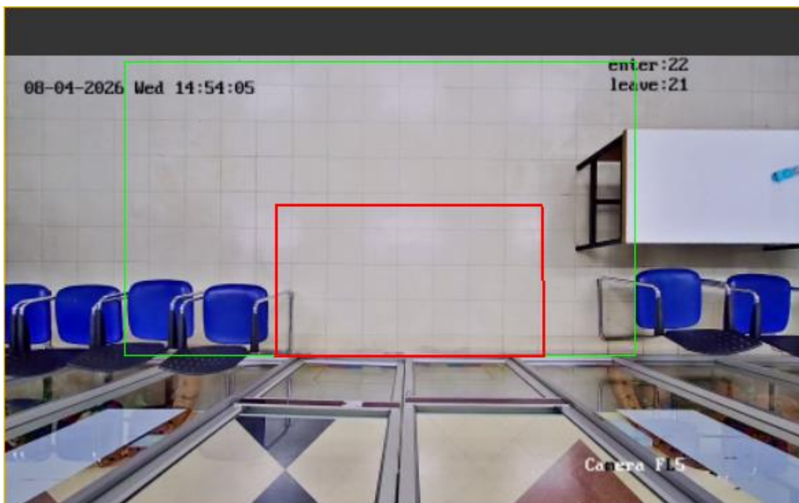
ภาพที่ 4.5 ภาพเส้นตรวจจับ (Detection Line) บริเวณกึ่งกลางทางเข้า-ออก
